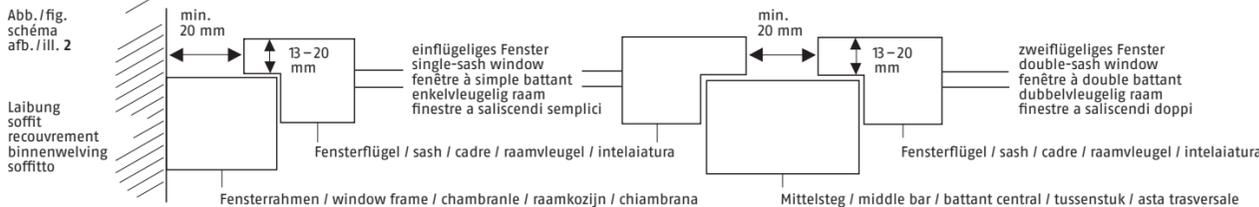
Abb./fig. schéma/afb./ill. 2
